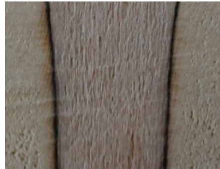
شکل ۱- برش طولی از یک اتصال دوبل جوشکاری شده: منبع: عمرانی و عیسی پور (۱۳۹۶)
