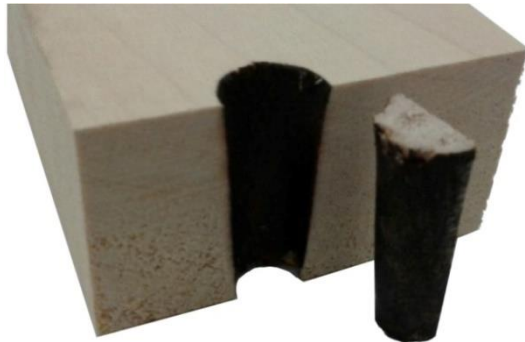
شکل ۱- برش طولی از یک اتصال دوبل جوشکاری شده: منبع: عمرانی و عیسی پور (۱۳۹۶)
