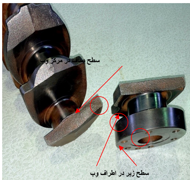
شکل 19: نواحی صاف و زیر در شکست خستگی
