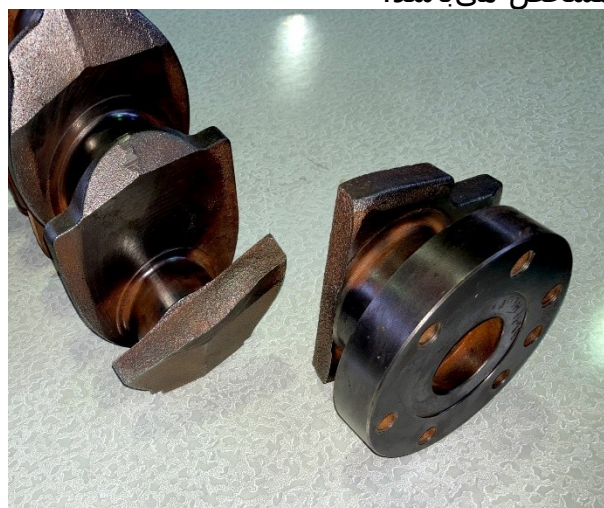
شکل 18: نمونه‌ای از شکست یک میل‌لنگ ناشی از خستگی
