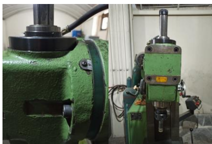
شکل ۲- تنظیم زاویه فک دستگاه بر روی ۳ درجه
