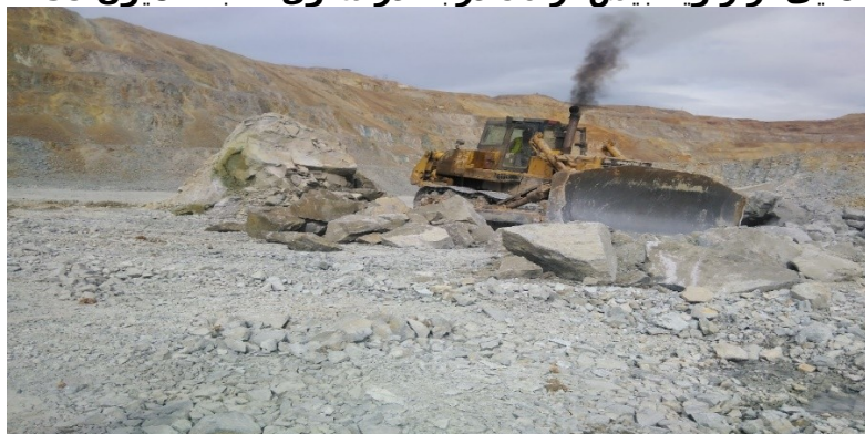
شکل 5: انجام بلدورزکاری بر روی پاشنه ها و جزایر باقی مانده بعد از برداشت جبهه کاری
