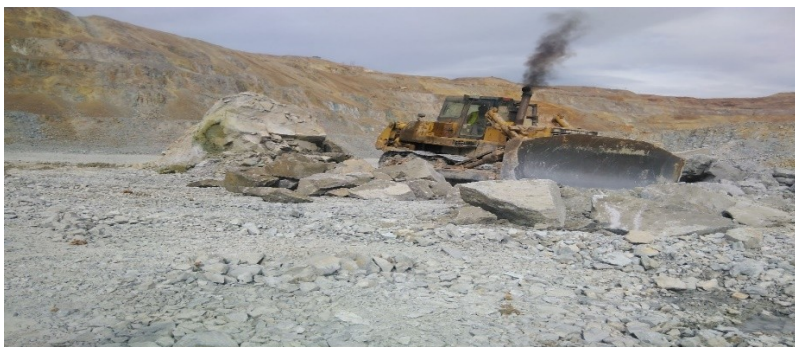
شکل 3: انجام بلدورزکاری بر روی پاشنه ها و جزایر باقی مانده بعد از برداشت جبهه کاری
