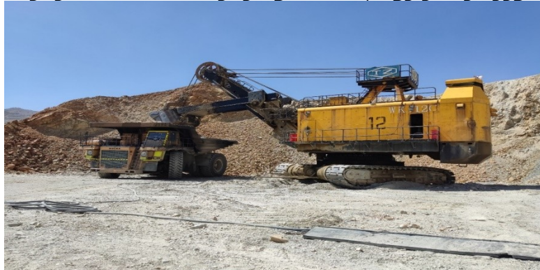
شکل 4: نمایی از زاویه بیش از 90 درجه در شاول T2 با کامیون 135 تنی بلاز
