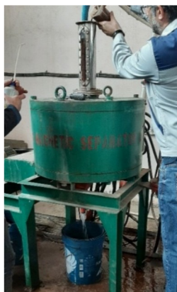
شکل 6- تصویر مربوط به آزمایش با جداکننده مغناطیسی اسلون
