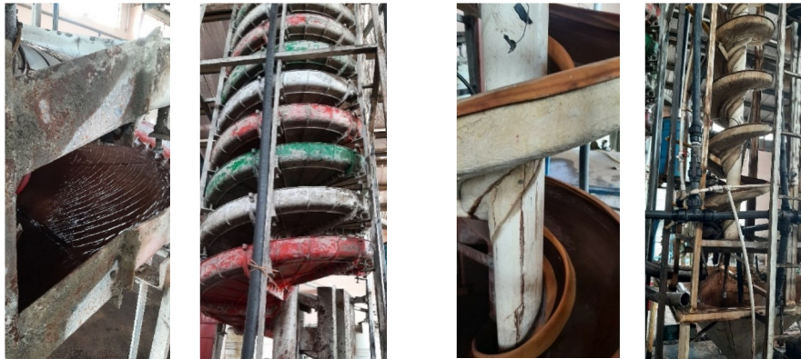
الف) اسپیرال اول ب) اسپیرال دوم شکل 4- تصاویر مربوط به آزمایش با اسپیرال
