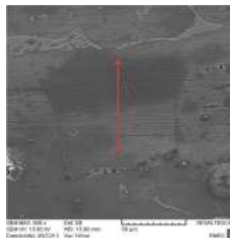
شکل ۱۶- ناحیه‌ی اتصال در نمونه‌ی اتصال داده شده در اتمسفر خلأ
