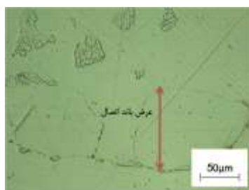
شکل ۱۳- ناحیه‌ی اتصال و محدودی متاثر از نفوذ در اتصال آرگون
