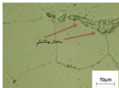
شکل ۸- ریز ساختار ناحیه اتصال در خلأ و ایجاد ساختار یوتکتیکی
