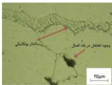
شکل ۱۲- ریزساختار محل اتصال در اتمسفر آرگون پس از اچ ماربل
