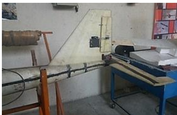
شکل ۱۲- نصب سروهای دم افقی و عمودی
