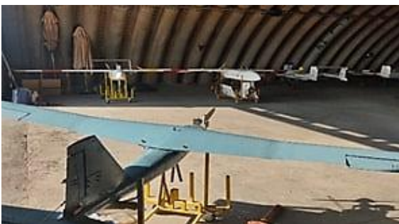
شکل ۱۴- پهپاد کامل شده و آماده تست پروازی
