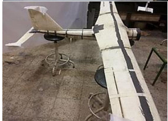
شکل ۱۱- یکپارچه سازی بعد از اتمام تمامی برشها
