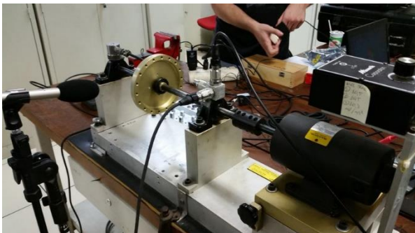
شکل ۵- سامانه شبیه‌ساز بروز عیب در موتور الکتریکی [۸]
