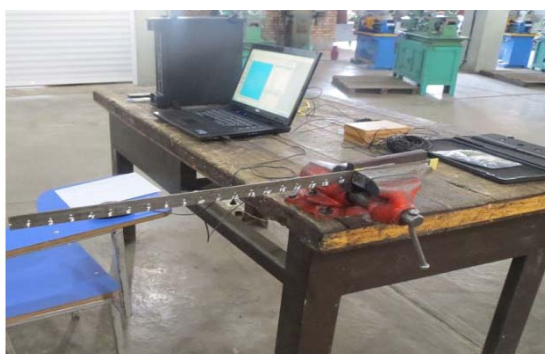
شکل (۱) تیر یکسرگیردار و تجهیزات تست مودال
