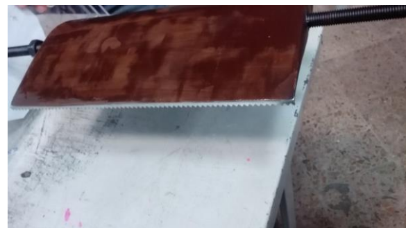
شکل ۴- مدل آزمایش به همراه فلپ با دالبور ۶۰ درجه
