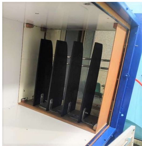
شکل ۴- نمای قرار گیری سه المان در دهانه تونل باد لایه مرزی
