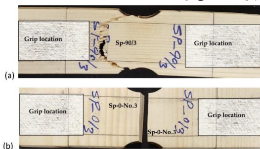
شکل ۴- قطعات شکسته شده در تست کشش از محل ناچ
