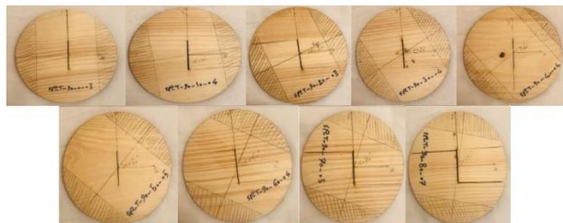
شکل ۱۰- قطعات تست در جهات مختلف زاویه بار-ترک در وضعیت ترک در راستای عمود بر الیاف
