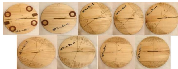
شکل ۹- قطعات تست در جهات مختلف زاویه بار-ترک در وضعیت ترک در راستای الیاف
