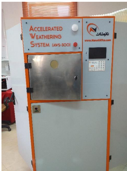
شکل ۶- دستگاه شتاب‌دهنده‌ی شرایط محیطی جهت شبیه‌سازی تابش نور خورشید
