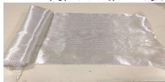
شکل ۲- الیاف شیشه تک جهته ۲۸۰ گرمی UD برای ساخت صفحه کامپوزیتی
