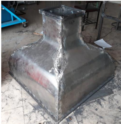
شکل ۱۴: نمونه فولادی ساخته شده بخش نازل با روش جوشکاری قوس الکتریکی دستی (SWAM)
