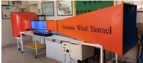
شکل ۱۶: تونل باد مادون صوت کم سرعت ساخته شده در آزمایشگاه آیرودینامیک
