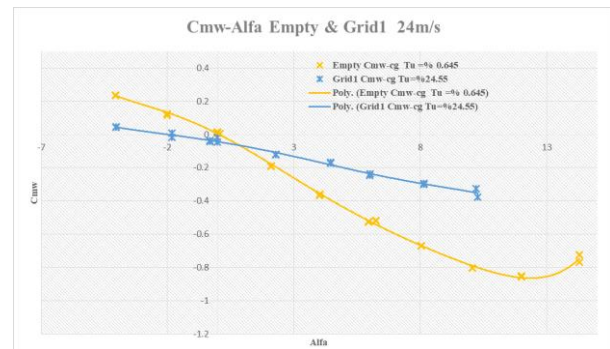
شکل ۱۴- تغییرات ضریب گشتاور پیچشی نسبت به زاویه حمله مدل در سطوح اغتشاش مختلف در سرعت ۲۴ متر بر ثانیه
