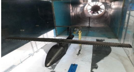
شکل ۵- مدل پهپاد نصب شده در محفظه آزمون
