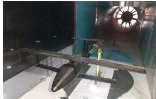
شکل ۹- مدل پهنپادی بال متصل دو بال نصب شده در محفظه آزمون
