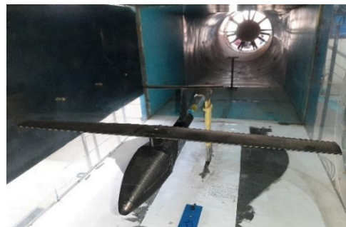
شکل ۸- مدل پهنپادی تک باله نصب شده در محفظه آزمون
