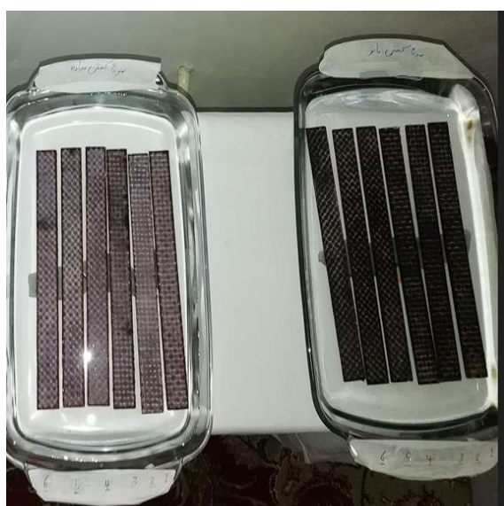
شکل ۶- نمونه‌های آزمون کشش بدون نانو و با نانو ذره آلومینیوم اکسید غوطه‌ور در آب مقطر
