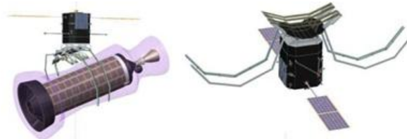
شکل ۳. استفاده از شاخک‌ها به منظور گرفتن جسم هدف [۷]
