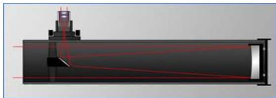
شکل ۵- مسیر اپتیکی در یک تلسکوپ نیوتنی [13]
