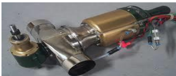
شکل ۱: نمونه موتور میکروتوربوشفت [۴]
