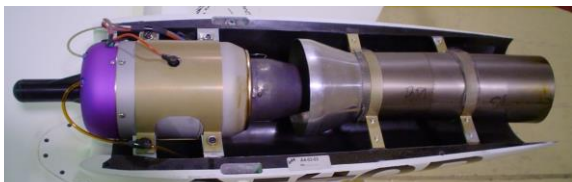
شکل ۵- نمونه موتور میکروتوربوپروجت با مجرای افزایش تراست [۲]
