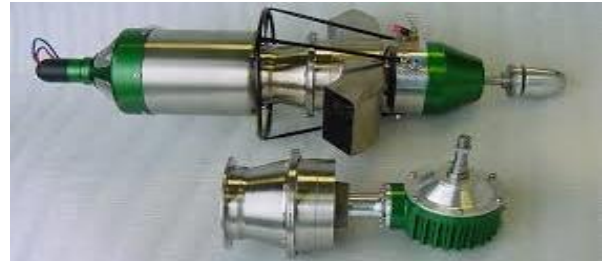
شکل ۲: تصویر نمونه موتور میکروتوربوپراجت [۴]
