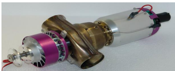
شکل ۶- نمونه موتور میکروتوربوپروجت تبدیل شده به میکروتوربوپراجت [۲]
