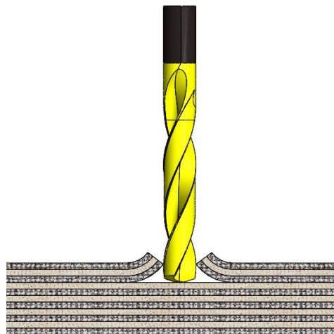
شکل ۳. آسیب لایه لایه شدگی در ورودی (Peel up)
