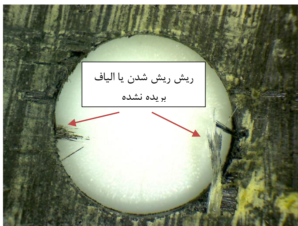
شکل ۷. آسیب ریش ریش شدن یا الیاف بریده نشده
