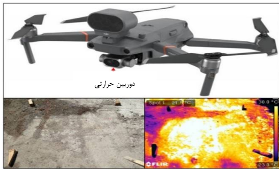
شکل 4- تجهیزات IR-UAV معمولی و داده های ترموگرافی نمونه [18]
