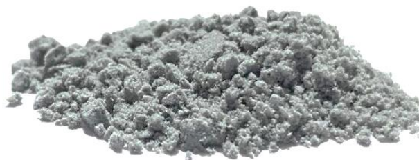
شکل ۲. رسوب حاصل از سنتز نانوهیبرید BC/Ni-Mn LDH
