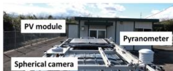
شکل ۱: عکاسی از ماژول PV و پیرانومتر نصب‌شده روی سقف ماشین
