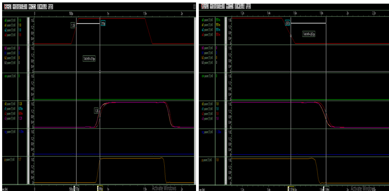
شکل ۶. از سمت چپ به راست به ترتیب زمان صعود (tr) و زمان نشست (tf) جمع‌کننده CLA
