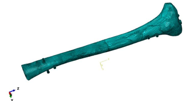
شکل ۹ نمای المان بندی شده مجموعه استخوان ، نیل و پیچ‌ها
