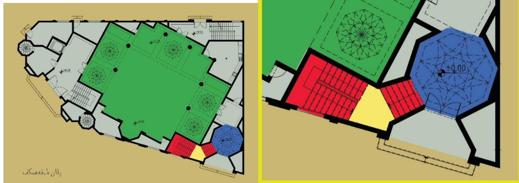
شکل ۳. احتمال اختلال در تخلیه جمعیت به دلیل فرم دوزنقه ای پلان و شکل نامنتظم پاگردها [۱۹]
