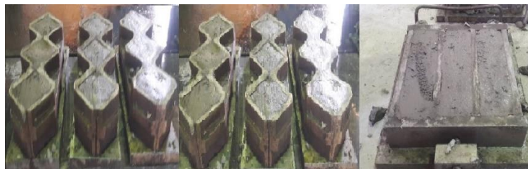
شکل ۵- قالب برای مقاومت خمشی، قالب برای مقاومت فشاری
