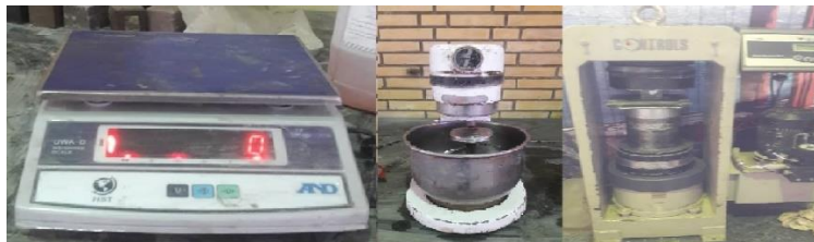
شکل ۴- جک تعیین مقاومت بتن، میکسر کوچک، دستگاه توزین
