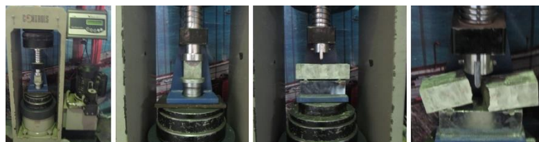
شکل ۷- نمونه‌های تحت آزمون خمشی و فشاری در محفظه مخصوص
