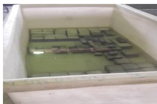
شکل ۶- حوضچه آب جهت عمل آوری بتن
