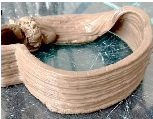
شکل 1. یک نمونه از لایه های چاپ شده که تحمل وزن لایه ی بعدی را نداشته اند [6]
