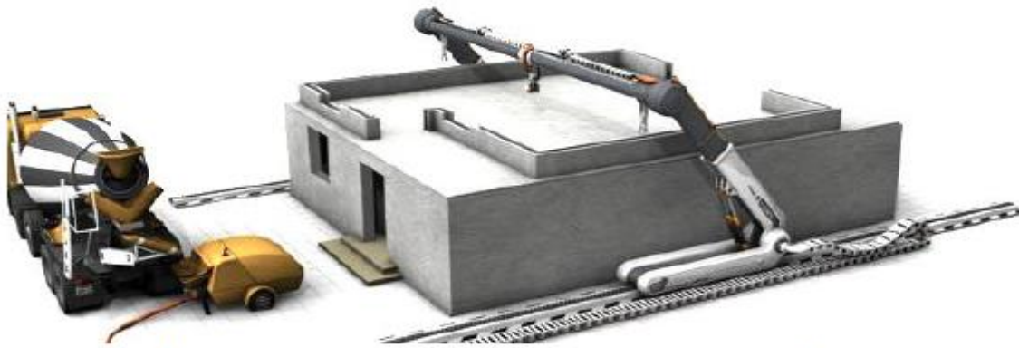
شکل 6. پرینتر سه بعدی ساختمان، با ساختار گانتی [15]
