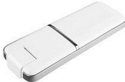
شکل ۴. یک مودم یو اس بی وایمکس برای اینترنت سیار
