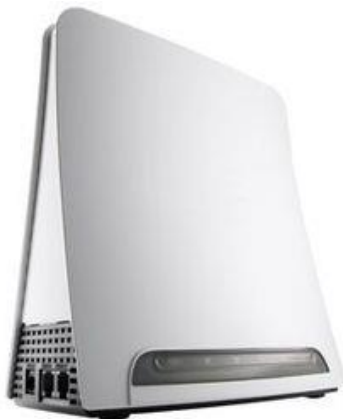
شکل ۳. یک دروازه (gateway) وایمکس که امکان اتصال اترنت، وای فای و VoIP را فراهم می کند
