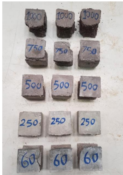
شکل ۳- تغییر رنگ نمونه ها در دمای بالا
