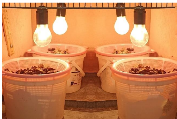
شکل ۲: تصویر دستگاه ساخته شده مشابه قیف برلیز (سمت راست)، توری نصب شده در کف هر ظرف (سمت چپ)
