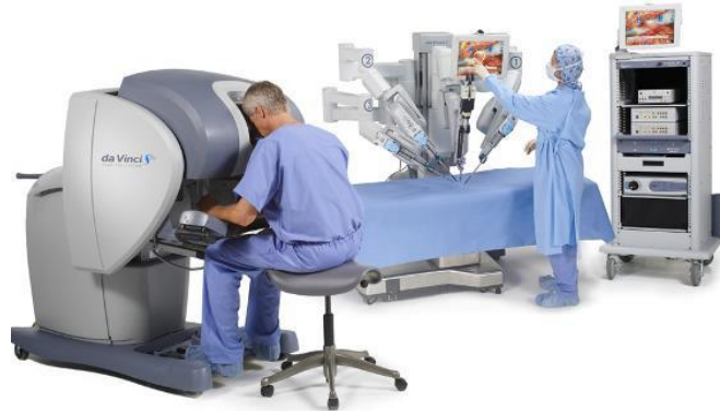
شکل ۱. سیستم جراحی HD S Vinci da جهت ادغام اندوسکوپ تریدی اچ دی و تکنولوژی رباتیک [11]
