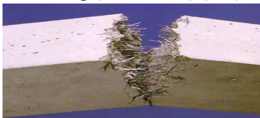
شکل ۷. توزیع الیاف فولادی در جهات مختلف
