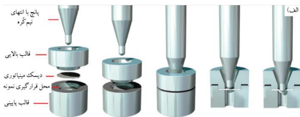
شکل ۱- شماتیکی از اجزا تجهیز آزمون پنچ کوچک [9].
