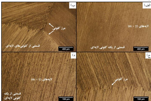
شکل ۳ - ریزساختار آلیاژ ۴۸۲۲ پس از همگن‌سازی الف) قسمتی از یک کلونی لایه‌ای، ب) مرز کلونی‌ها و ج) و د) بزرگ‌نمایی بالاتر.
