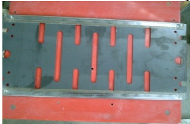
شکل 5 - نمونه یک مقاومت صفحه‌ای سالم
