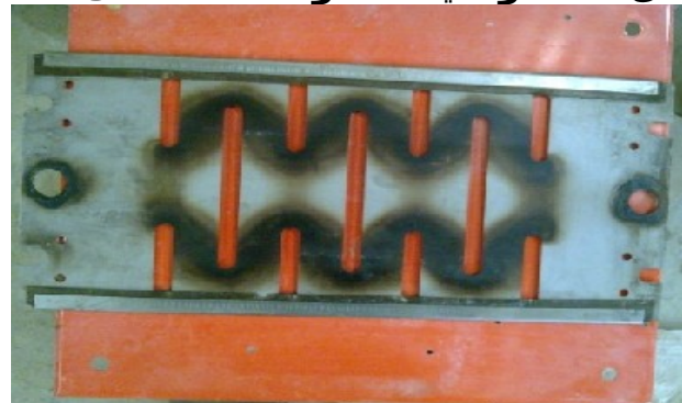
شکل 6 - نمونه یک مقاومت صفحه‌ای معیوب
