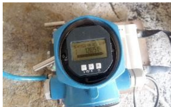
شکل 4 : دبی فن در دمپر 1005 باز اندازه گیری شده تجهیز در دمپر 100% باز
