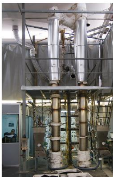
شکل ۱ سیستم مورد استفاده جهت آزمایشات کربوناسیون و تکلیم در بستر سیال [۵]
