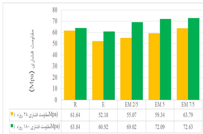
شکل 7- مقاومت فشاری 28 و 180 روزه نمونه ها حاوی درصد های مختلف 5/2، 5 و 5/7 میکروسیلیس
