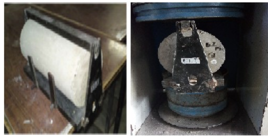
شکل 2- الف) نمونه در زیر فک برای اعمال فشار، ب) نحوه مهار نمونه آزمایش
