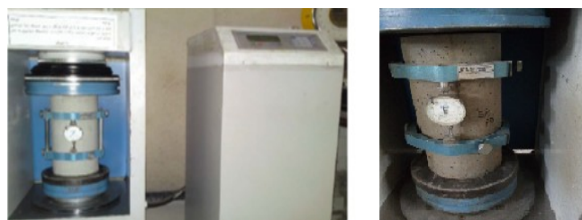
الف) طریقه قرار گرفتن کرنش سنج بر روی نمونه ب) قرار گرفتن نمونه در دستگاه
