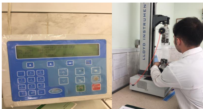
شکل ۱۶- تست کشش تار و پود
