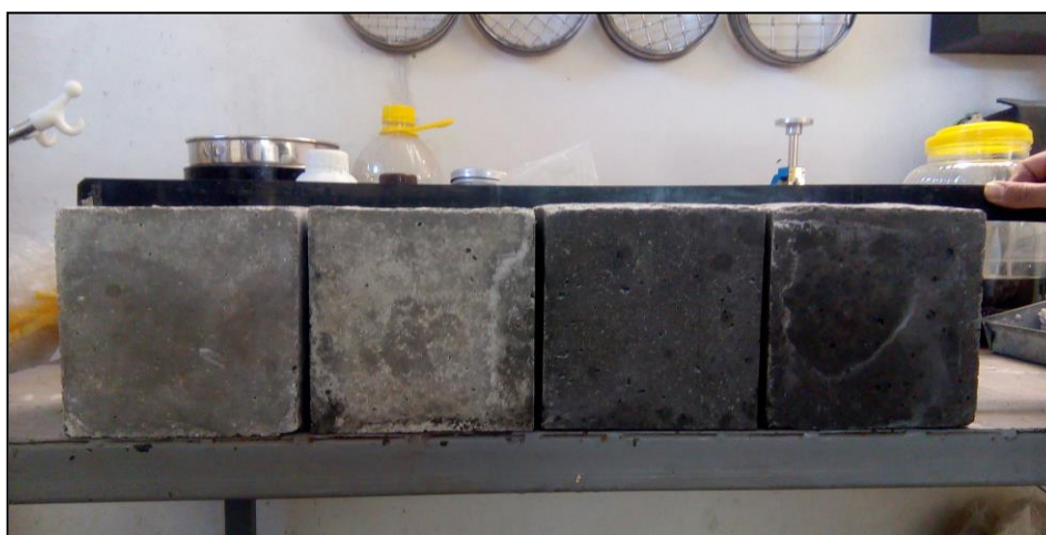
شکل ۸. انحنای بوجود آمده در سطح بتن
