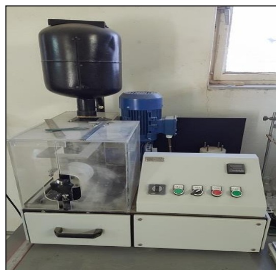
شکل ۵. دستگاه آزمایش مقاومت سایشی
