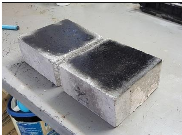
شکل ۶. آماده سازی نمونه جهت انجام آزمایش مقاومت سایشی
