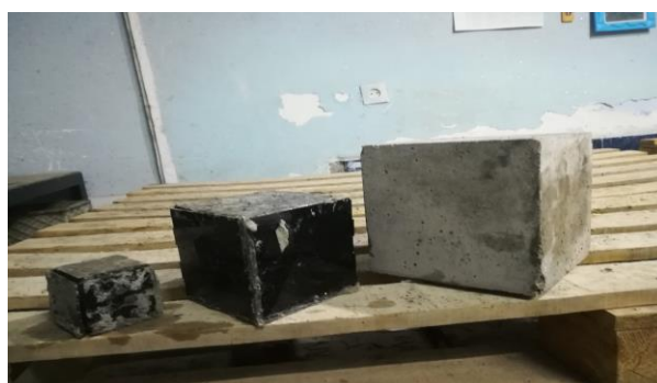
شکل ۵- نمونه های بتنی مکعبی ساخته شده با ابعاد ۵۰، ۱۰۰ و ۱۵۰ میلی متر
