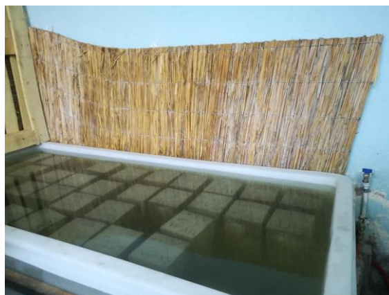
شکل ۴- حوضچه عمل آوری نمونه های بتنی در شرایط استاندارد
