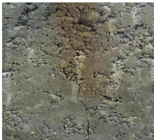
شکل ۷. نحوه ترک خوردگی نمونه حاوی الیاف شیشه
