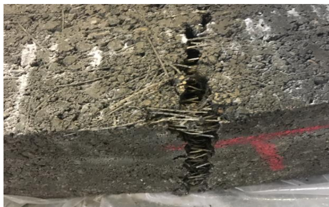
شکل ۹. نحوه ترک خوردگی نمونه حاوی الیاف سنتتیک
