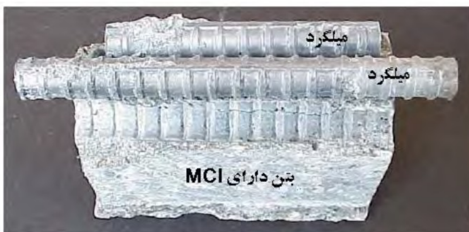
شکل ۱۰- عدم خوردگی در بتن دارای MCI بر پایه کربوکسیلیت
