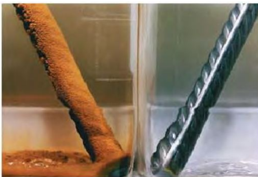
شکل ۹- آرماتورهای غوطه ور شده در آب دریا. الف) آرماتور با MCI ب) آرماتور بدون MCI
