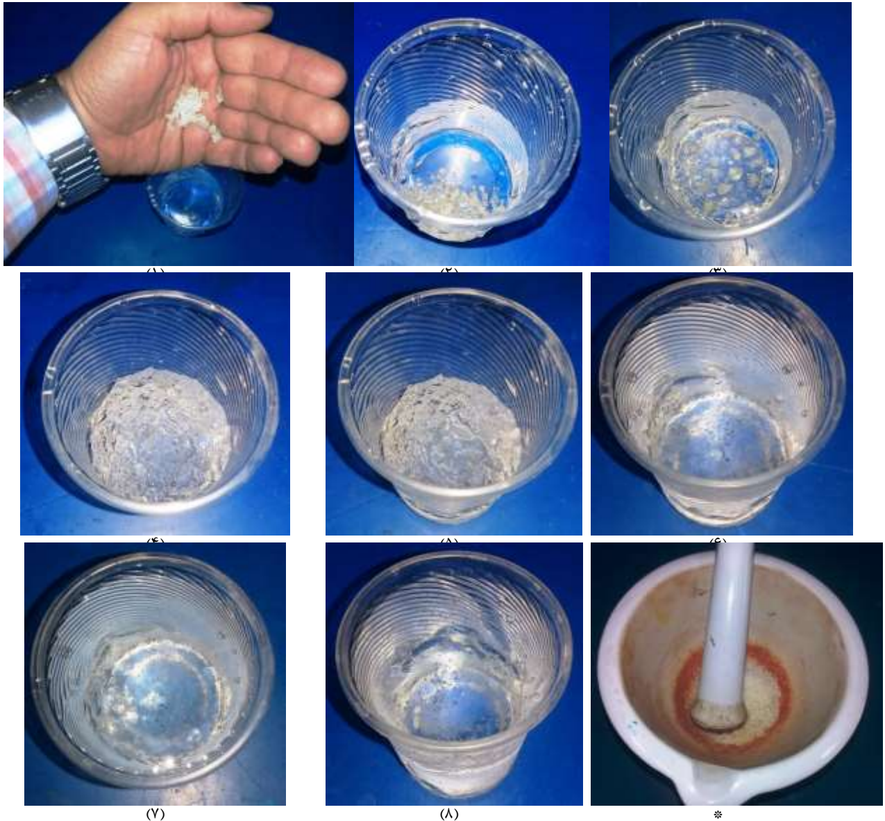
شکل ۲- آماده سازی مواد به دو صورت پودر و ژل برای مصرف در مخلوط های بتنی
