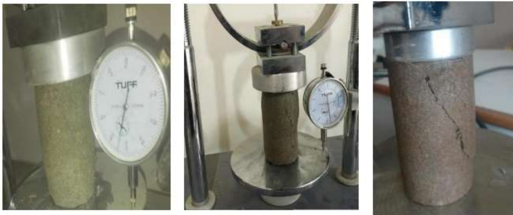
شکل ۳. مکانیزم شکست در نمونه‌های با درصد مختلف نانوسیلیس
