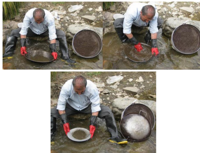
شکل 3. مراحل لاوک شویی نمونه های کانی سنگین
