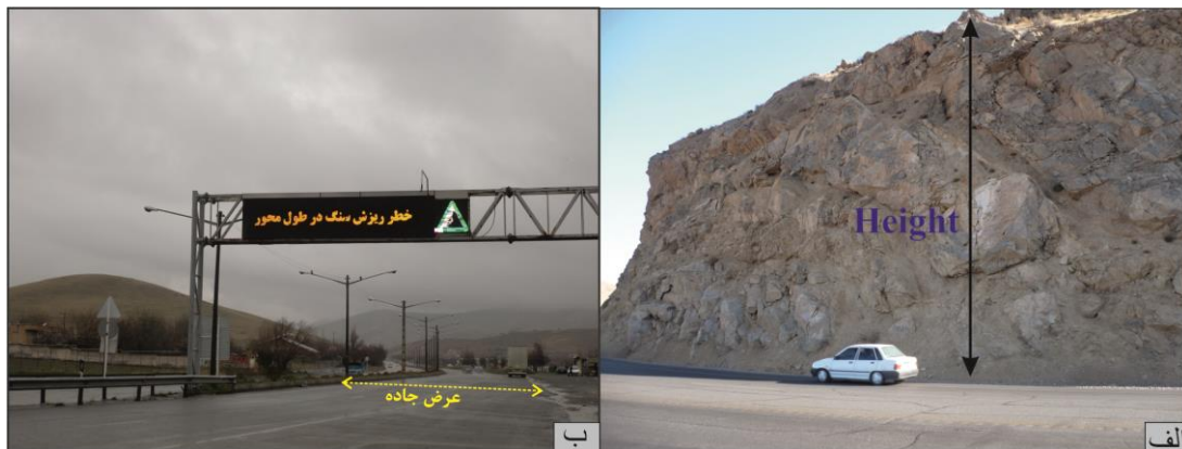
شکل ۵. نحوه اندازه‌گیری پارامترهای ارتفاع دامنه و عرض جاده
