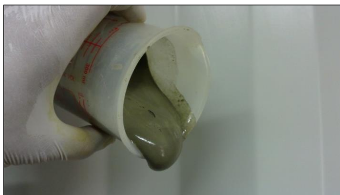
شکل ۲. نمایش ژل‌شدگی مناسب جزء B دوغاب تزریقی
