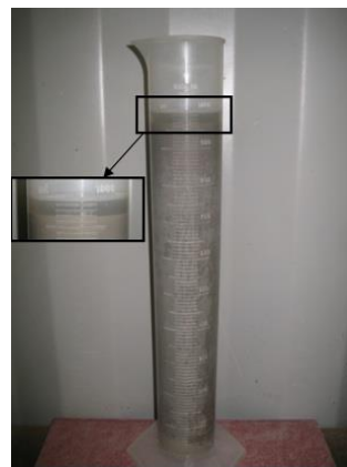
شکل ۱. نحوه اندازه‌گیری زمان قیف مارش (شکل سمت چپ) و میزان آب‌انداختگی (شکل سمت راست) برای ساخت جزء A دوغاب دوجزئی
